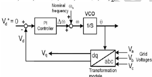
Fig.3. DQ-PLL Structure
